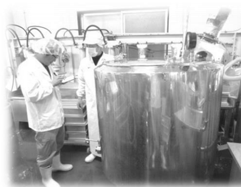
きぬ豆腐豆乳冷却タンク
